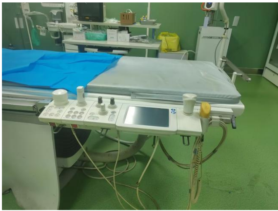
图 3-8 介入一室诊断床应急按钮
