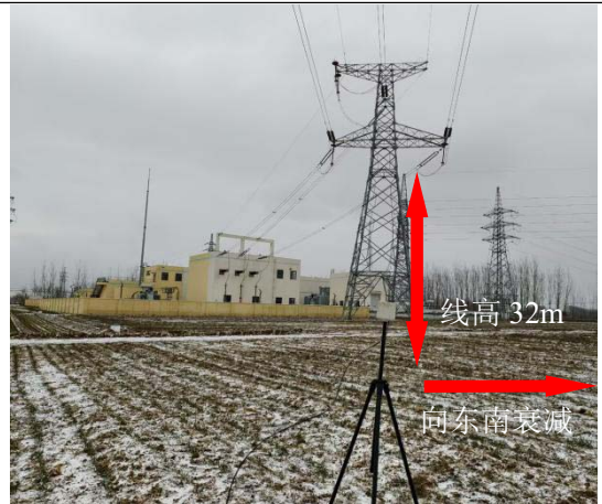
图 7-15 220kV 杜宏线单回架空线路衰减示意图
