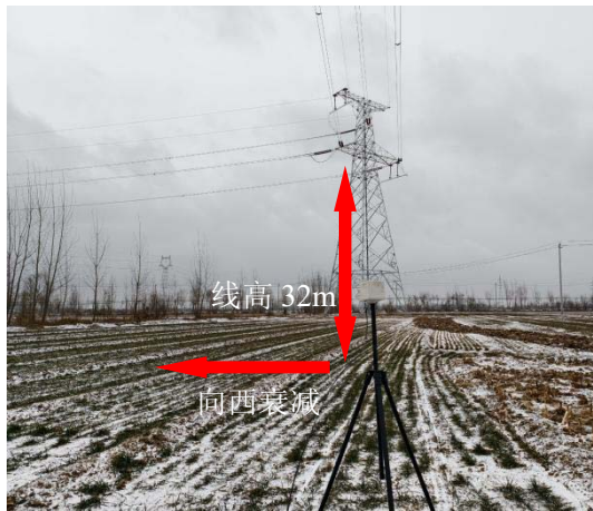
图 7-16 220kV 时宏线单回架空线路衰减示意图
