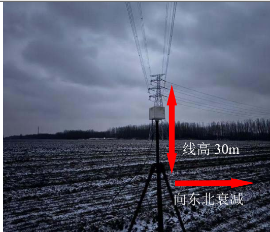
图 7-14 220kV 杜宏线/时宏线双回架空线路衰减示意图
