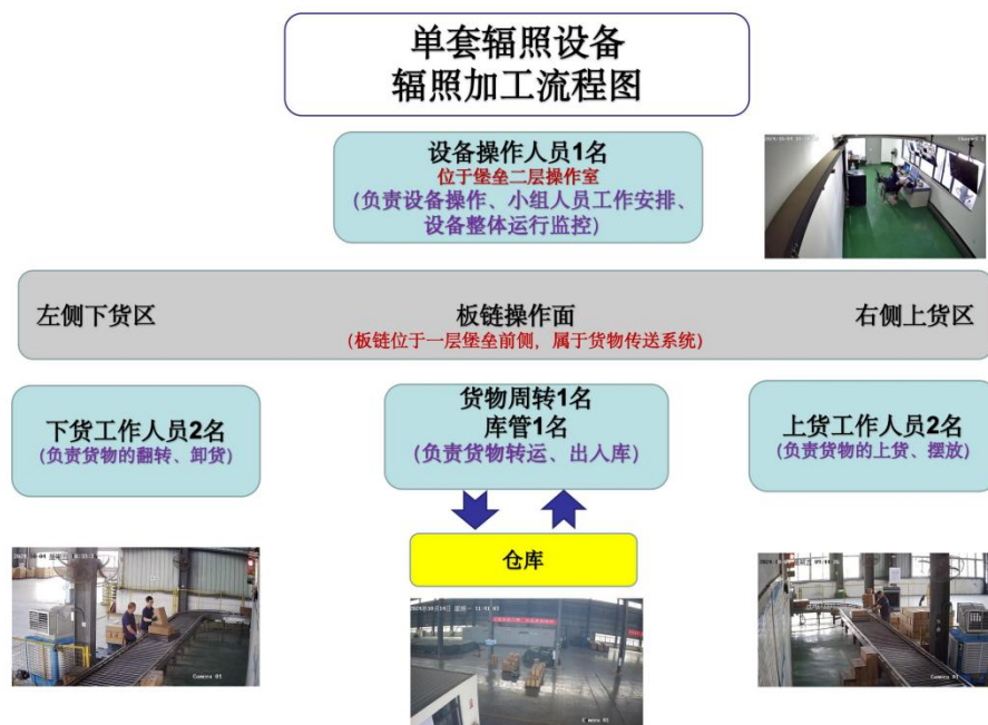
图 2-21 (a) 工业辐照加速器辐照加工流程图
